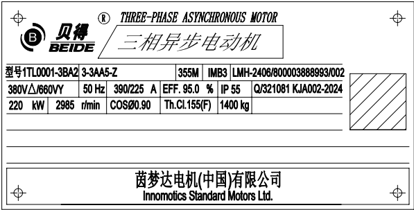
1TL0001 系列电机铭牌 1TL0001 Motor Nameplate
