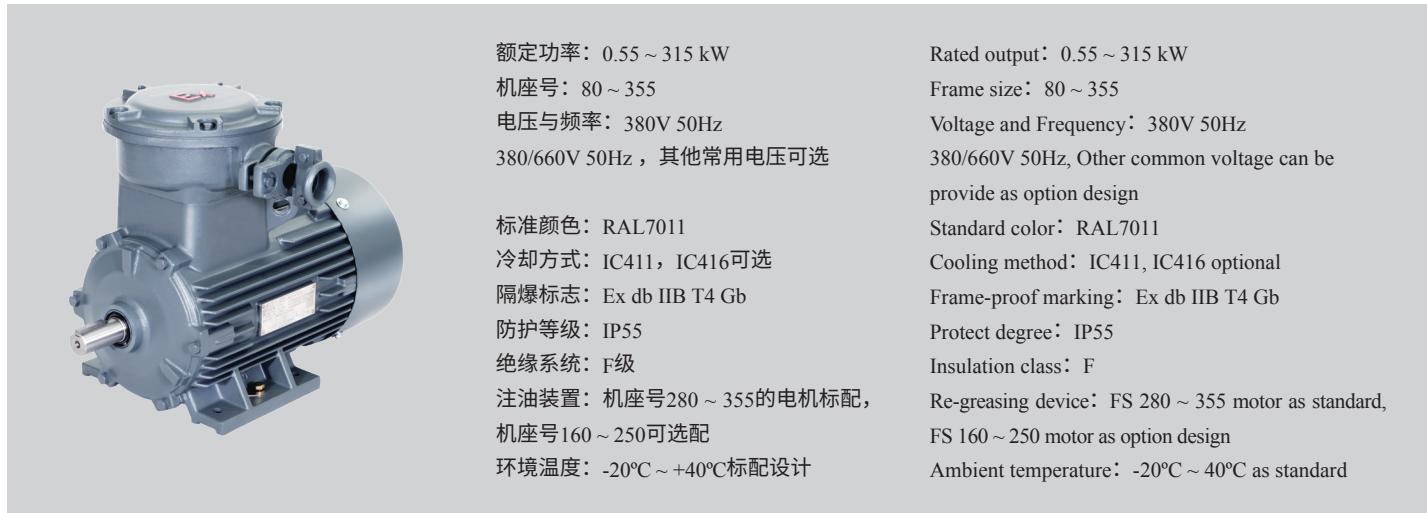
1MT0003系列高效隔爆型全封闭、自扇冷三相异步电动机是一款全新产品。该系列防爆电机完全符合IEC 60079-0:2017 / IEC 60079-1:2017以及GB/T 3836.1-2021 / GB/T 3836.2-2021等设计标准，防爆等级为Ex db IIB T4 Gb且防爆性能通过CQST认证。其效率达到IEC 60034-30 IE3高效等级要求(50Hz)，符合GB 18613-2020能效等级三级。
