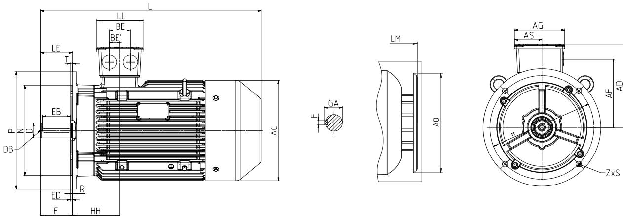
表 2 Table2 - 当接线盒在左边 (第 16 位“6” ) 时的底脚尺寸 Data for terminal box on left (16th digit 6)
